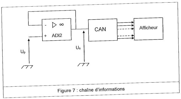
L'amplificateur différentiel intégré ADI2 est considéré comme parfait. Il est alimenté sous deux tensions + 12 V et - 12 V. La conversion s'effectue sur 8 bits.
