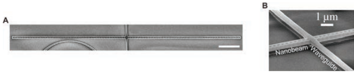
FIGURE 3 – Images au microscope électronique de la structure suspendue guide d’onde-nanopoutre. (A) Sur cette image, le guide d’onde correspond au court segment vertical et la nanopoutre au long segment horizontal. La longueur de la barre d’échelle blanche est de 5 \mu\text{m} . Les modes TE et TM sont injectés par une extrémité du guide d’onde. L’arc en bas à gauche est une sonde de mesure des oscillations par couplage de nanocavités photoniques résonantes. (B) Comme le montre cette vue de la jonction entre la nanopoutre et le guide d’onde, ces éléments sont parfaitement solidaires et suspendus au-dessus du substrat.
