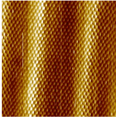
FIGURE 3 – Image par microscopie à effet tunnel de la surface Au(111). La taille de la zone imagée est 10nm x 10nm. Le réseau hexagonal des atomes de la surface Au(111) est observé. Les lignes plus claires correspondent aux atomes hors site, elles permettent de repérer les directions de type \langle 11\bar{2} \rangle .
